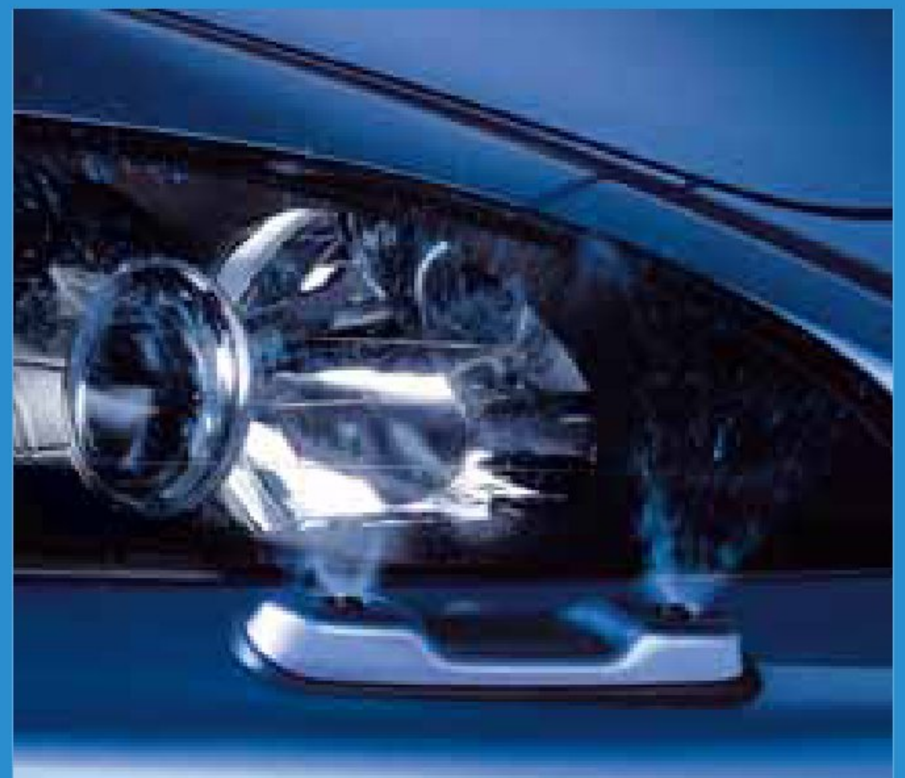
Die standardmäßige, kraftvolle Scheinwerfer-Reinigungsanlage gewährleistet eine effektive Lichtausbeute der dreistrahligen Xenon-Projektionsscheinwerfer (HID).
