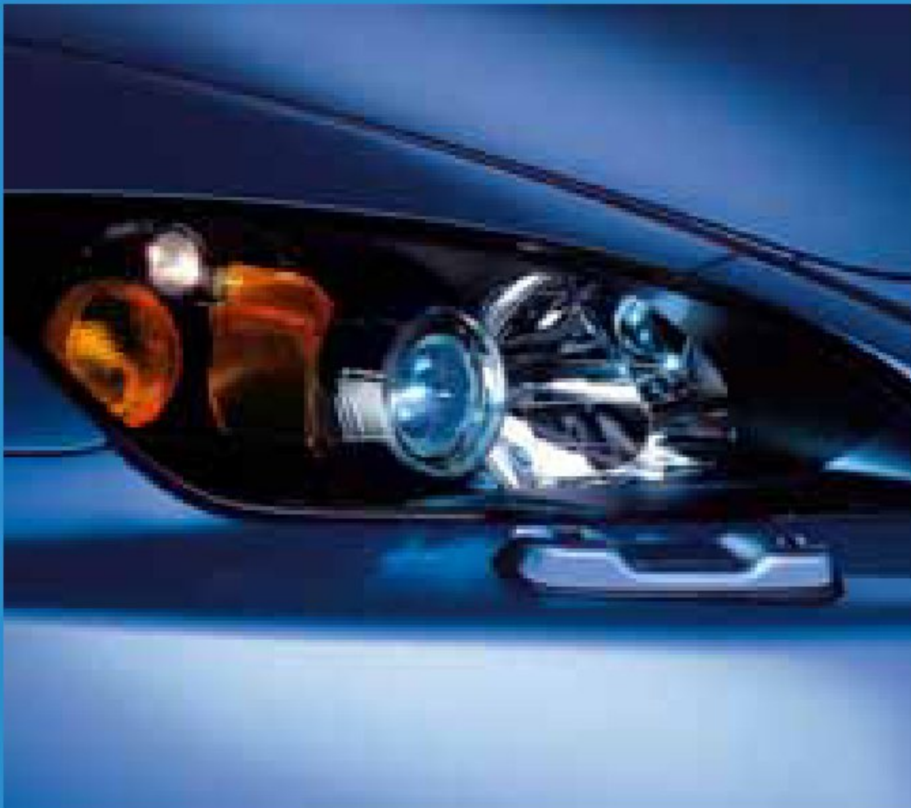
Die dreistrahligen Xenonprojektionsscheinwerfer (HID) sorgen für beste Beleuchtung selbst bei schlechten Lichtverhältnissen. Sie werden geschützt durch eine aerodynamisch geformte, stoßfeste Scheinwerferabdeckung.
