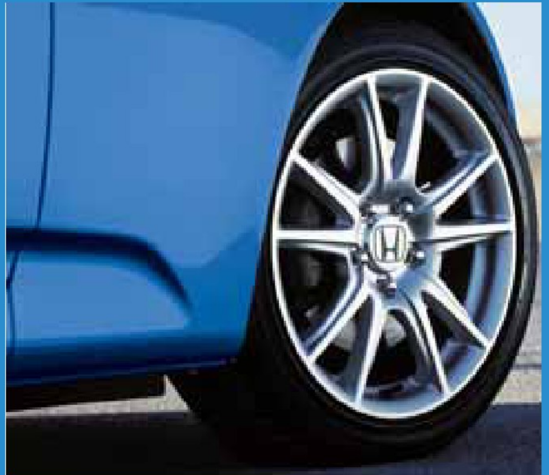
Die 17-Zoll-Aluminiumfelgen sehen nicht nur beeindruckend aus, sondern verbessern auch die Bodenhaftung.
